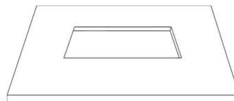
4、确定水槽下端缘的安装位置，用铅笔画出轮廓线，在下端缘四周打上一圈密封胶，将水槽放在安装位置，抹去溢出来的密封胶。
