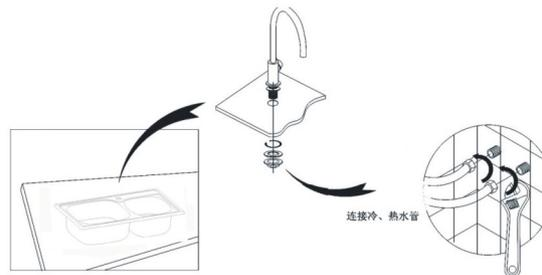
3、水槽台面安装，确定待安装的台面，已按水槽的安装尺寸开好孔（安装开孔尺寸：为小于底部轮廓周边10-20mm的安装□）。
